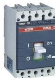
کلید اتوماتیک **mccb** که دارای دو مدار حفاظت حرارتی و حفاظت مغناطیسی در خود است. این کلید معمولاً به عنوان کلید اصلی در تابلوهای برق استفاده می شود و بیشتر در جریانهای بالای 100 آمپر ساخته می شود.
