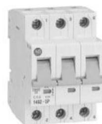
کلید اتوماتیک **mcb** که دارای دو مدار حفاظت حرارتی و حفاظت مغناطیسی در خود است. این کلید معمولاً به عنوان کلیدفرعی در تابلوهای برق استفاده می شود و بیشتر در جریانهای زیر 100 آمپر ساخته می شود.
